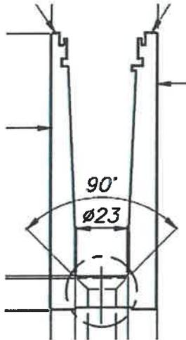
In das Klemmprofil - aus Aluminium EN AW 6060 T6 - mit der Bezeichnung E1800130, Einzellänge  $\leq 3000$  mm, werden VSG-Scheiben aus 2 x 8 mm ESG aus Float / 1,52 mm PVB mittels Kunststoffkeilen mit der Bezeichnung E1805600 eingeklemmt. Weitere Details enthält [1].
